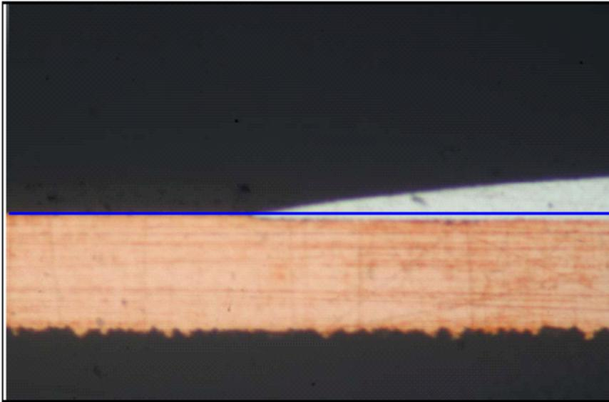
**Abb. 7:** Kupferauflösung unter der Zinnschicht.
